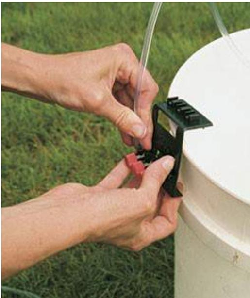
Figura 4. Attaccare un tubicino a ciascuna delle tre porte della valvola, l'altro estremo di ogni tubicino sarà collegato ai soffioni.
