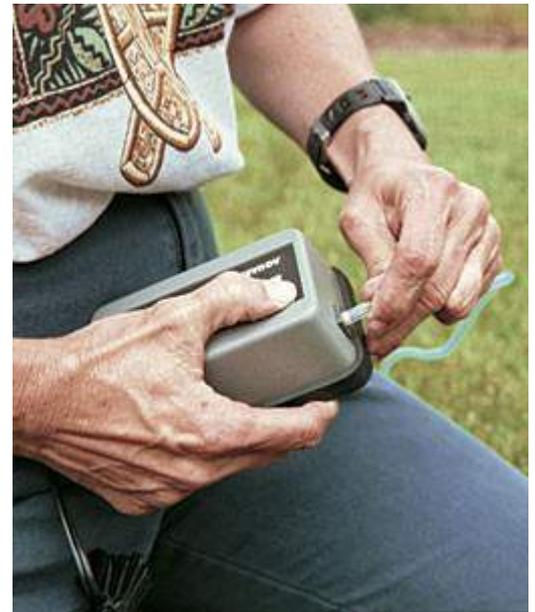
Figura 3. Attaccare un'estremità di un tubicino alla pompa, l'altro estremo sarà collegato alla valvola a tre.
